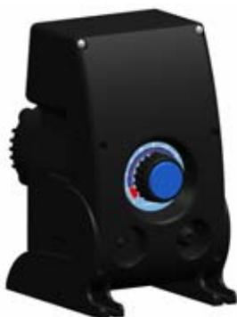
Регулировка длины хода пистона осуществляется в диапазоне 0-100% и производится при помощи ручки регулировки, расположенной на задней крышке насоса. На практике применяется рабочий диапазон 20-100%. Ручка защищена от случайных поворотов, поэтому для изменения показаний необходимо нажать на нее, а затем повернуть до требуемого значения.
