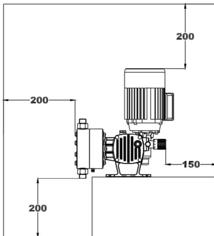
Рис.3 – минимальное рабочее пространство насоса (мм.)
